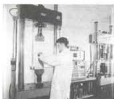
航空機外板の疲労試験 Fatigue testing of aircraft skins
